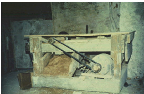
Serra circular desprotegida constitui perigo para o operador. Ela deve ter a coifa de proteção e ser operada somente por trabalhador qualificado. Veja foto 72.
