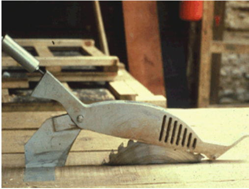
Serra circular apresentando coifa de proteção, conforme preconiza a NR 18.
